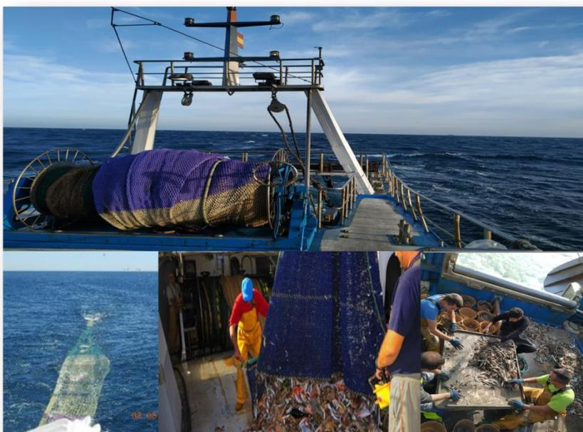
*Figura 2. Maniobra de arrastre. Recogida de la red, volcado de captura y separación de capturas comerciales y del descarte (triaje).*
