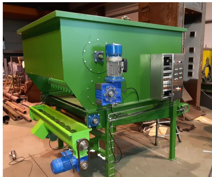
Figura 3. Tolva dosificadora y sinfín de alimentación.
