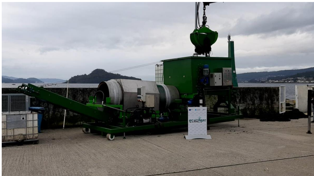
Figura 1. Equipo de limpieza de algas de arribazón.
