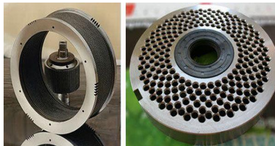
Figura 8. Anillo móvil de la peletizadora anular.
