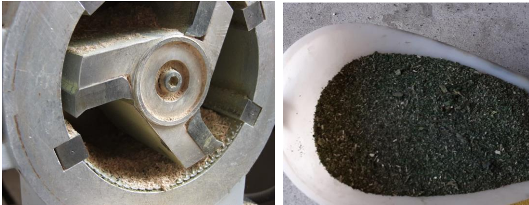
Figura 7. (a) Molino de cuchillas con malla 1 mm; (b) Fracción granulométrica resultante de alga.
