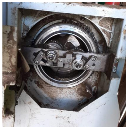
Figura 11. Matriz de peletizado con rodillos de presión.
