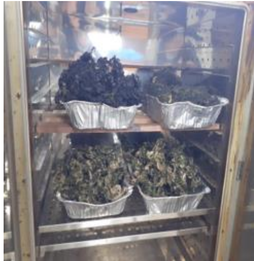
Figura 6. Secado forzado de muestras de algas en cámara.
