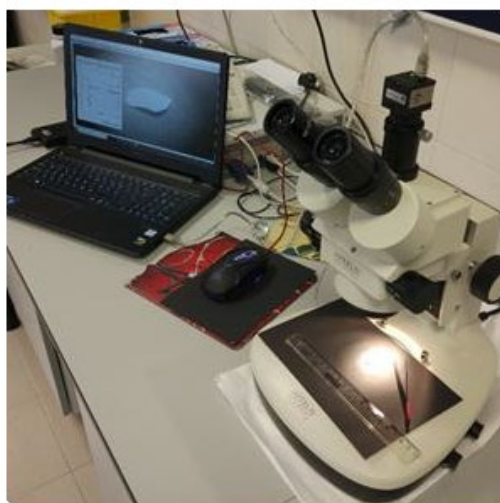
Figura 23. Izquierda: software de selección de perfil UEyeCockPit: Derecha: Lupa con cámara acoplada y plantilla milimetrada.
