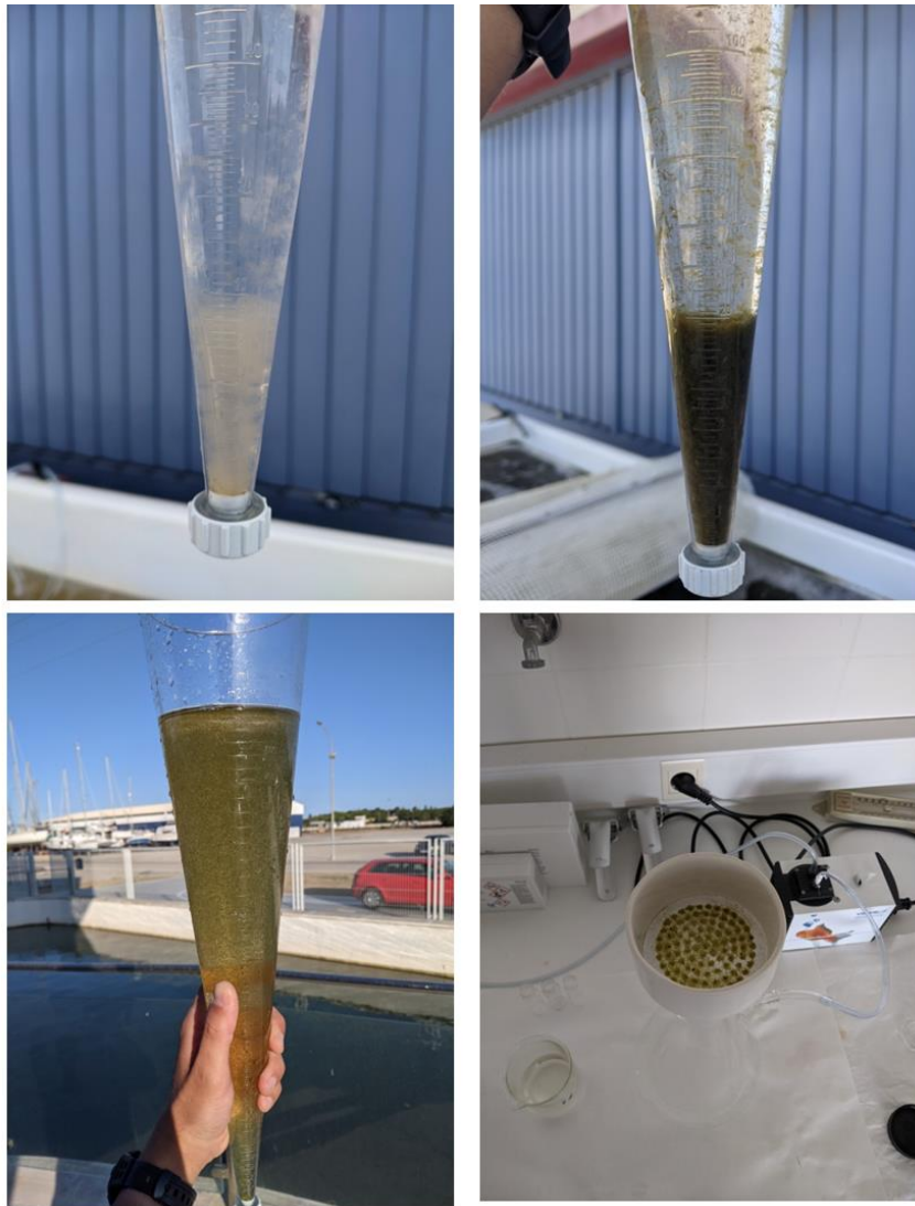
Figura 4. (a) Volumen de flóculos en cono Imhoff al principio de la prueba. (b) Volumen de flóculos maduros en cono Imhoff durante el cultivo de las lisas. (c) Muestra de agua con flóculos en suspensión. (d) Medición de los sólidos en suspensión totales con un filtro GFC.
